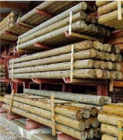
Lange Rundhölzer mit Entspannungsschnitt, gestapelt zum Trocknen
