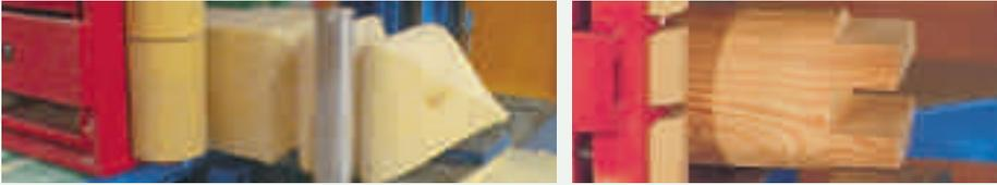
Holzverbindungen, Falze, Auskerbungen und sonstige aufwendige Bearbeitungen werden auf unseren CNC gesteuerten Bearbeitungszentren passgenau gefertigt.
