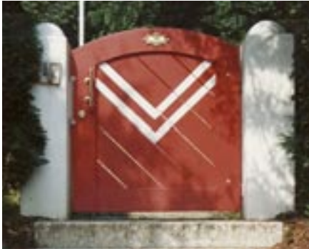
Gartentürfl schwerer, verzapfter Rahmen, kesseldruckimprägniert, nachgetrocknet, 2x farbig lasiert.
