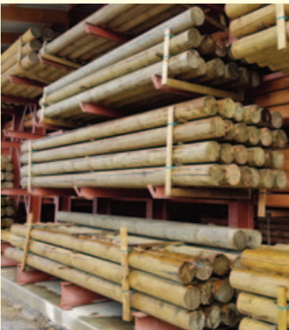
Lange Rundhölzer gestapelt zum Trocknen
