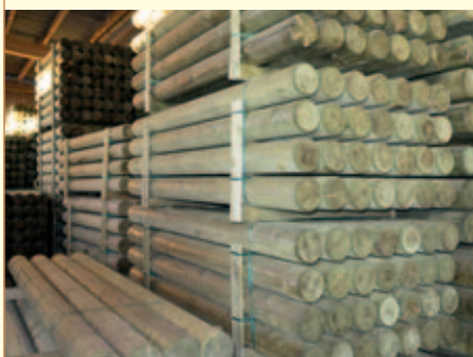
Sämtliche Palisaden werden bis zur Rissbildung getrocknet und nach der Kesseldruckimprägnierung unter Dach gelagert
