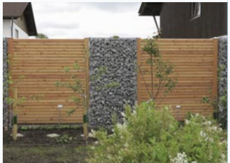
Zaungabionen mit Lärchen-Rhombuslattenzaun kombiniert. Auf Maß gefertigt.
